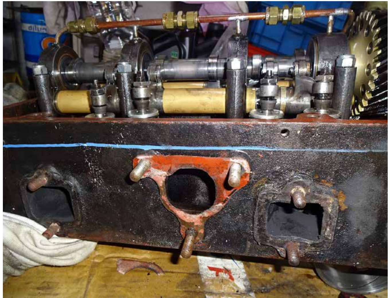
Foto 73: Der von Bob West in den 1940er Jahren entwickelten Zylinderkopf für eine Lancia Lambda
