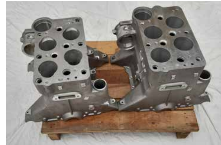
Foto 86: Lancia Lambda-Zylinderblöcke (links frühe Serie, rechts spätere Serie)
