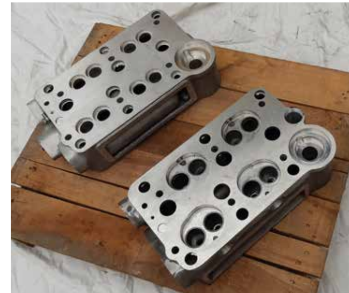
Foto 87: Lancia Lambda-Zylinderköpfe (links frühe Serie, rechts spätere Serie)
