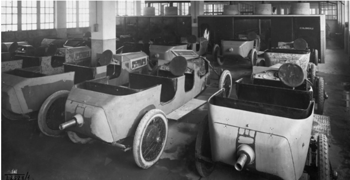
Foto 24: Warteschlangen vor den Lackierkabinen
